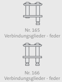
Verlängerte Bolzen mit Sicherungsringnute
