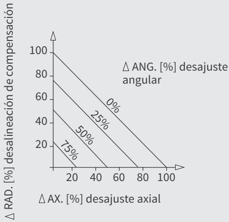
[fig 03] factor de desajuste f<sub>1</sub>
