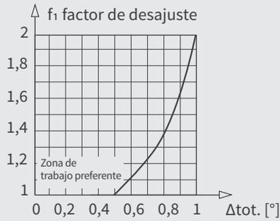
Nota: hay que tener en cuenta el cambio en el desajuste que se producirá durante el funcionamiento. P.ej., debido a la dilatación térmica.
