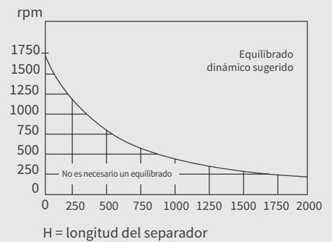
Equilibrado; Los elementos estándar Renoldflex están equilibrados según el grado G6.3 de la norma BS ISO 1940-1:2003. Se recomienda un equilibrado adicional para aplicaciones por encima de las curvas de velocidad de la [fig 05] y la [fig 06].
